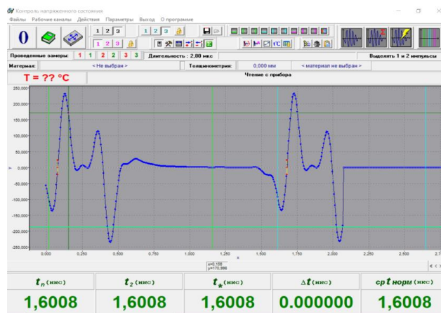
Рисунок 3 – Главное окно программы «Контроль напряжённого состояния» для периода сигнала, заданного генератором: 1,6 мкс
