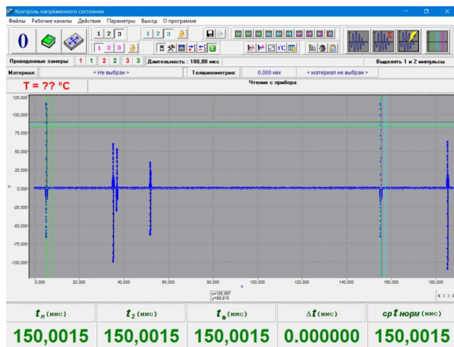
Рисунок 6 – Главное окно программы «Контроль напряжённого состояния» для периода сигнала, заданного генератором: 150 мкс.
