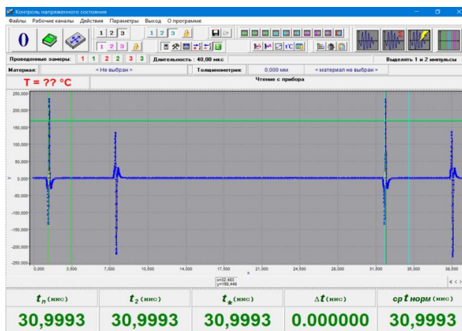
Рисунок 3 – Главное окно программы «Контроль напряжённого состояния» для периода сигнала, заданного генератором: 1,6 мкс
