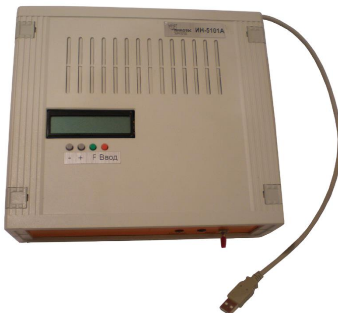
Рисунок 3.6 - Вид на верхнюю панель блока обработки прибора ИН-5101А Кнопочная клавиатура и экран предназначены для настройки параметров выполнения измерений (см. п.4.4.2.2)
