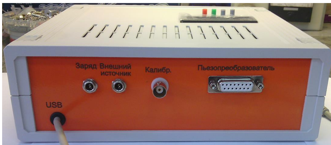
Рисунок 3.3 - Вид на обратную панель блока обработки прибора ИН-5101А исполнения 01 ЗАРЯД — разъем для подключения зарядного устройства; ВНЕШНИЙ ИСТОЧНИК — разъем для подключения внешнего источника питания постоянного тока (напряжение — 6,0...6,5 В, максимальный ток — 1,5 А); КАЛИБР . — разъем CP-50 (BNC) для проведения тестирования прибора (при работе не используется); USB — кабель для подключения блока к ПК из комплекта поставки; ПЬЕЗОПРЕОБРАЗОВАТЕЛЬ — разъем для подключения ПЭП
