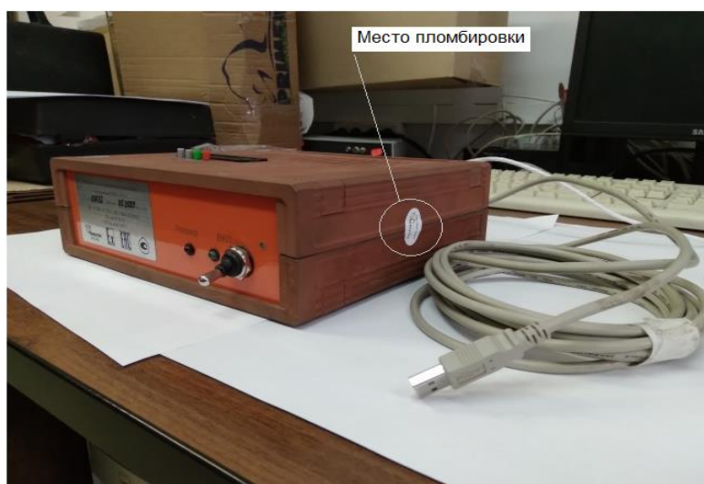
Рисунок 3.4 – Общий вид и вид на лицевую панель блока обработки прибора ИН-5101А исполнения 02 Назначение органов индикации и управления – аналогично рисунку 3.2.
