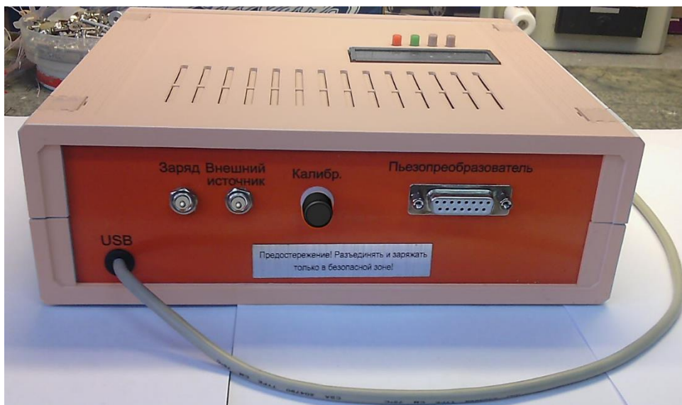
Рисунок 3.5 - Вид на обратную панель блока обработки прибора ИН-5101А исполнения 02 Назначение органов подключения – аналогично рисунку 3.3
