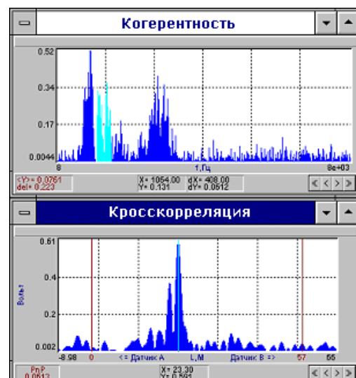
Рис.40. Определение места утечки (полоса анализа 1064- 1472 Гц).
