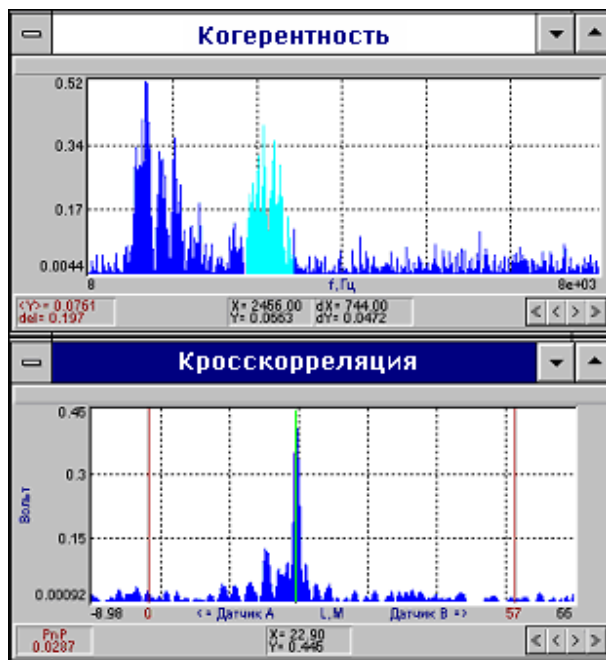
Рис.41. Определение места утечки (полоса анализа 2456- 3200 Гц).
