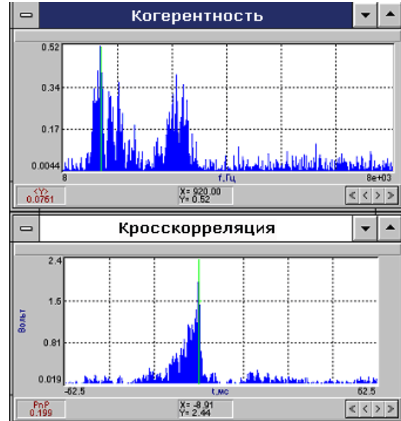
Рис.38. Вид функций когерентности и взаимной корреляции при выявлении утечки.
