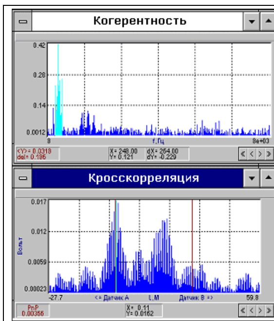
Рис.57. Определение места 2-й утечки за датчиком А, установлен против ж/дома 330.
