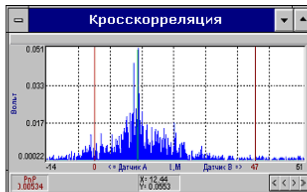
Рис.59. Функция взаимной корреляции, полученная при простукивании по схеме на рис.58.
