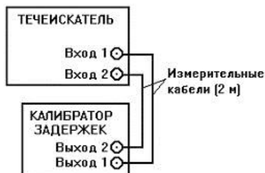
Рис.26. Схема для тестирования рабочих станций с помощью калибратора временных задержек
