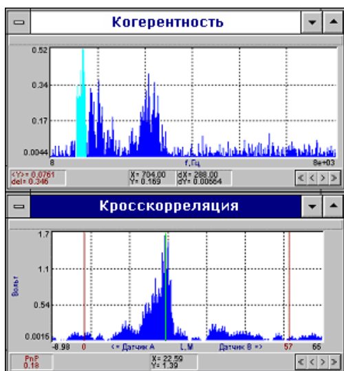
Рис.39. Определение места утечки (полоса анализа 704- 992 Гц).
