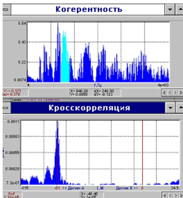
Рис.34. Функции когерентности и взаимной корреляции и окно "Поиск утечек" на экране течеискателя при тестировании трубопровода.
